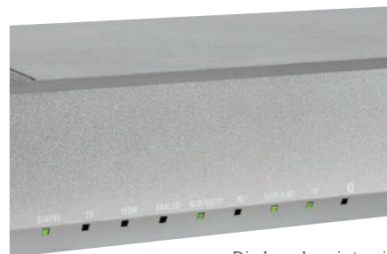
Diody po lewej stronie wskazują różne funkcje, ale gdy reguluje się głośność, zgodnie wyświetlają pasek adekwatny do natężenia dźwięku.
