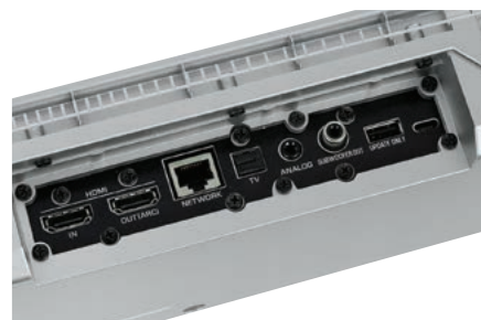
HDMI obsługuje 4K/ HDCP2.2, wyjście na telewizor ma kanał zwrotny. Wejścia audio, analogowe i cyfrowe służą w zasadzie do podania sygnału z TV, gdyby ten nie wysłał sygnału zwrotnego przez HDMI. USB jest przeznaczone do aktualizacji oprogramowania.
